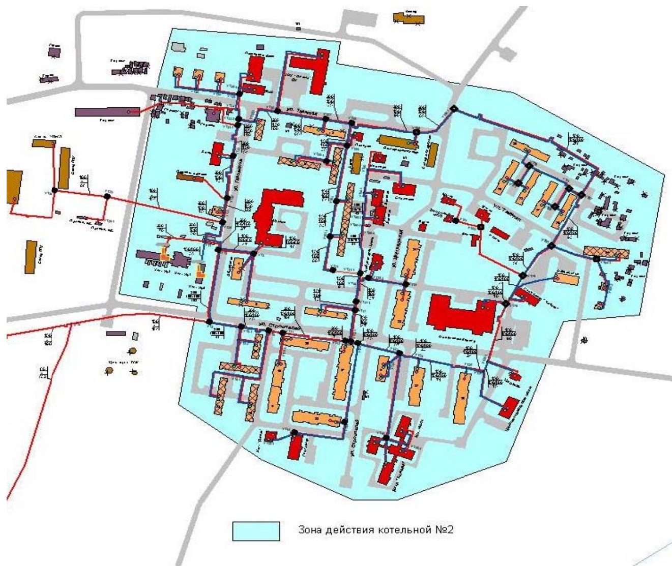
Рис. 2.2. Зона действия котельной №2
